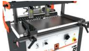
BORING 54 PRESTIGE: Masivní litinová bo ní pravítka s odm ováním a lupou
