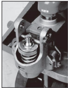
Obr. 4: Kontrola pojistného kolíku
