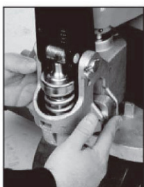
Obr. 11: Vložení řetízku do vačky
